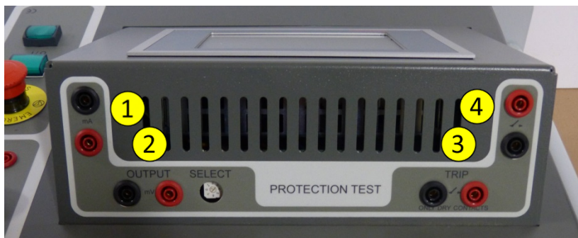
Figure 6 : Unité de contrôle : Connexions relais de protection DC
