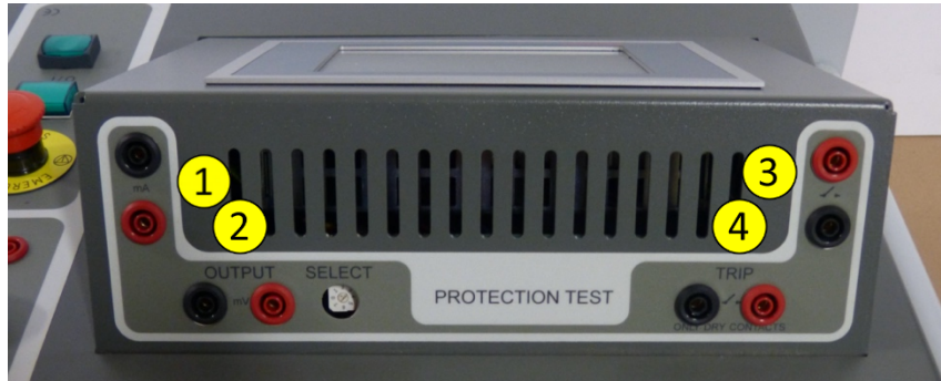
Figure 9 : Unité de contrôle : Connexions BALTO Controller – Relais de Protection DC
